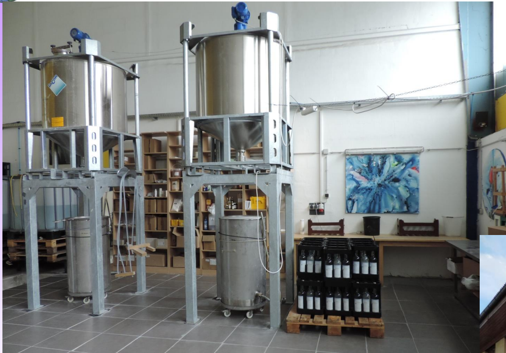
Stahltanks mit Rührwerk und Absetztanks.
